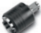
ПАТРОН ДЛЯ БЫСТРОЙ СМЕНЫ ИНСТРУМЕНТА ДЛЯ МЕТЧИКА РАЗМЕРА 2 С ХВОСТОВИКОМ WELDON 3/4" Применяется только для магнитных станков для корончатого сверления с функцией левого вращения. Для метчиков по стандарту DIN 371 и 374/376, в комбинации с насадками для нарезания резьбы, с предохранительной муфтой M6—M20 или без нее.
