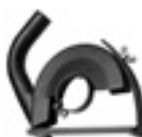
ЗАЩИТНЫЙ КОЖУХ С ПЫЛЕОТСОСОМ с салазками для отрезных кругов Ø 180 мм, глубина реза 40 мм, примыкание Ø 32 мм
