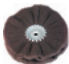
НЕТКАНЫЙ МАТЕРИАЛ ДЛЯ ШЛИФОВАНИЯ с появлением волнистости, ширина ок. 30 мм, отверстие 14 мм, для снятия небольших заусенцев, окисных пленок, выполнения легких шлифовальных работ, декоративной обработки
